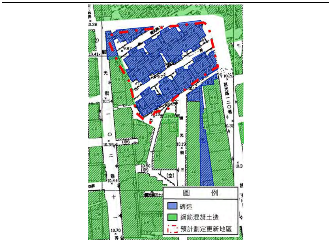
圖7 更新地區範圍內原有建物構造示意圖(已於 102.8.5 拆除完成)
