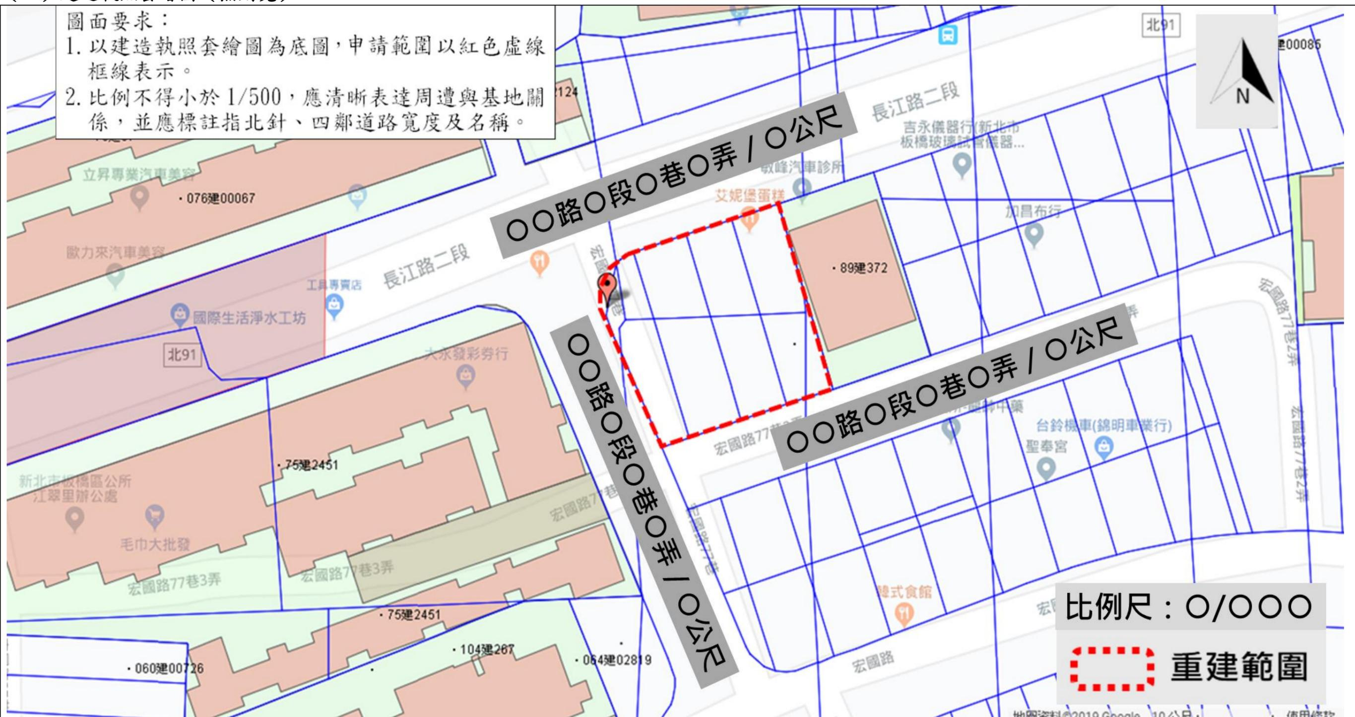
建造執照套繪圖  已確認建築基地未達 200 平方公尺且鄰接合法建築物基地屋齡均未達 30 年 (危老容獎辦法第 4 條之 1)
