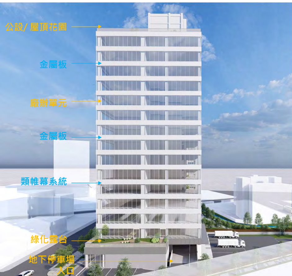
West Elevation 西向立面
